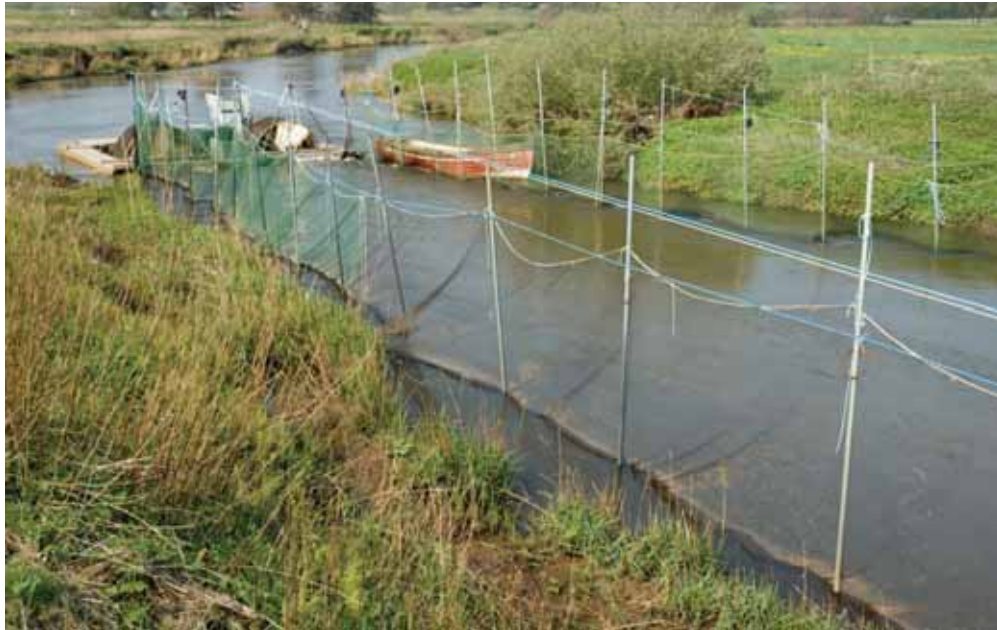
Figur 3. Smoltfælden ved Bur. Garnraderne på hver side leder fiskene mod de to tromler. Foto: H. Baktoft
