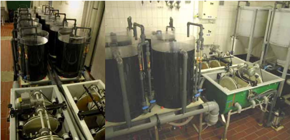
Figur 14. Projektet produktionsanlæg. Til Øverst til venstre ses anlæggets produktionstanke og nederst til venstre og yderst til højre ses anlæggets filterstationer til høst af nauplier.
