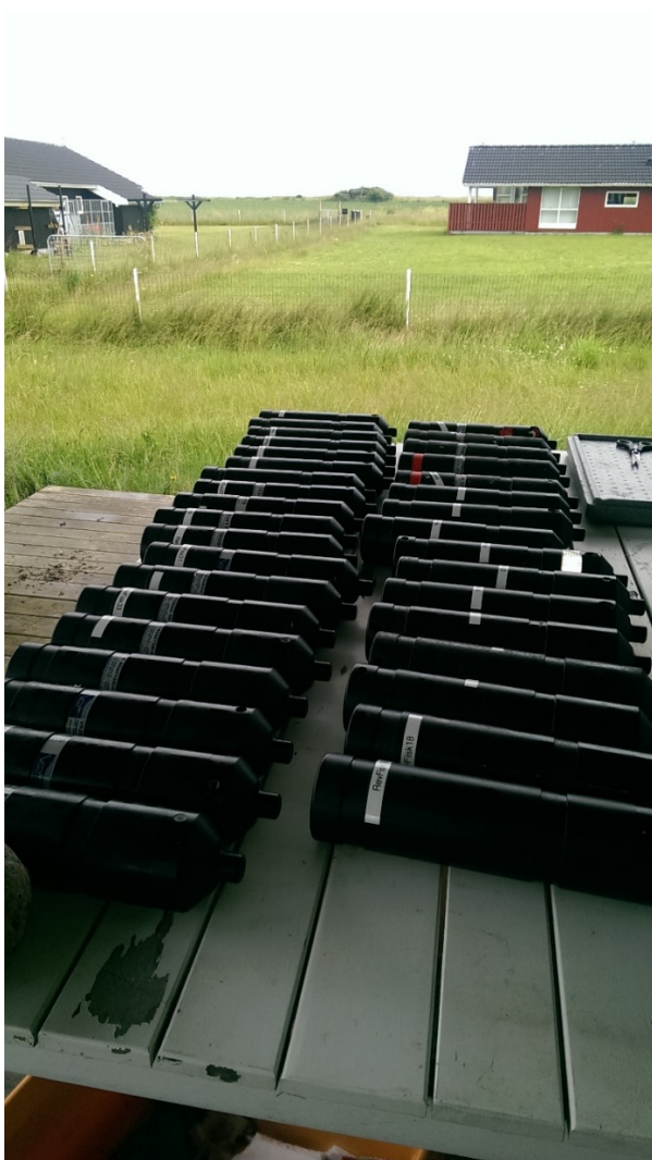
Hydrofoner klar til at blive placeret strategisk omkring revet for at undersøge torskens adfærd omkring rev.
