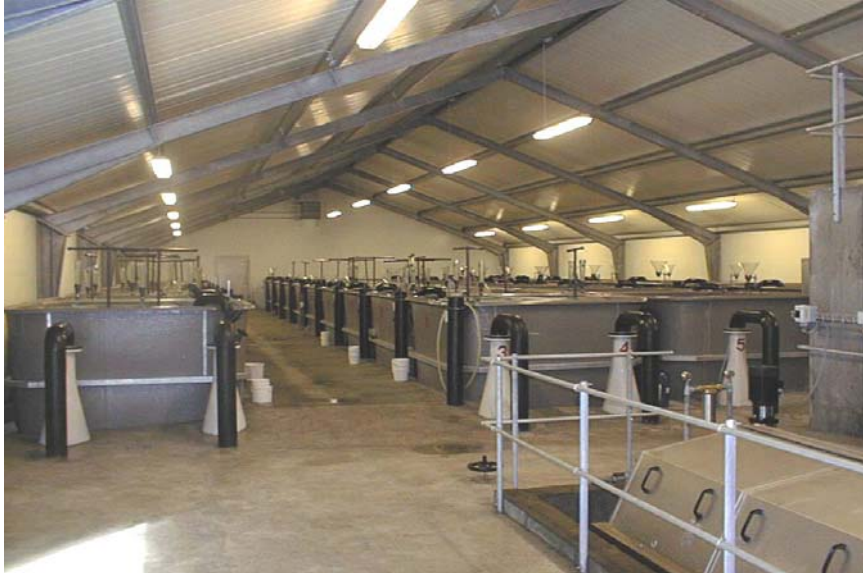
Fig. 5. Avlshal 2 med 40 stk kar. Foran karene ses iltkegler og til højre ses tromlefilter og et hjørne af biofilteret.
