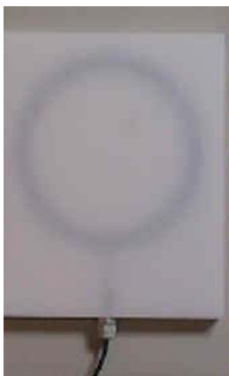
Fig. 11. Antenne til on-line registrering af pit-tag nummer i database.
