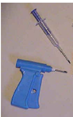
Fig. 10. Sprøjte og pistol med stempel og kanyle til injektion af pit-tag i fisk.
