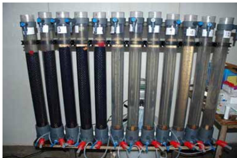
Fig. 8.2. Forsøgsopstillingen t.v. muliggør opretholdelse af en veldefineret brintoverilte koncentration v.h.a. brintoverilte probe og styring med ElectroCell ® doseringsudstyr der forsyner systemet med en 3 % H_2O_2 opløsning. Billedet ovenfor viser opstilling med reaktorrør med 5 biofilter elementer af typen Bioblok-150. Vandvolumen er 2,8 L, biofilterareal estimeret til 0,25 \text{ m}^2 .
