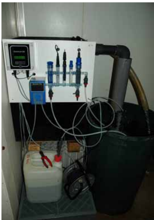
Fig. 8.2. Forsøgsopstillingen t.v. muliggør opretholdelse af en veldefineret brintoverilte koncentration v.h.a. brintoverilte probe og styring med ElectroCell ® doseringsudstyr der forsyner systemet med en 3 % H_2O_2 opløsning. Billedet ovenfor viser opstilling med reaktorrør med 5 biofilter elementer af typen Bioblok-150. Vandvolumen er 2,8 L, biofilterareal estimeret til 0,25 \text{ m}^2 .
