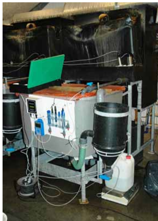
Fig. 9.3.1. Forsøgsopstilling med ElectroCell måle- og doseringsudstyr til HP (udstyr på front af karret). T.h. for vægten er HP reservoir på vægt.
