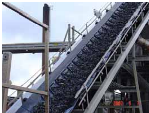
Tegning 4.1. Der udtages prøver to steder i opsorteringen af muslingelandingerne på de virksomheder der indgår i undersøgelsen. Fotos 1: transportør som løfter fangsten til sorteringstromle der vises på fotos 2.
