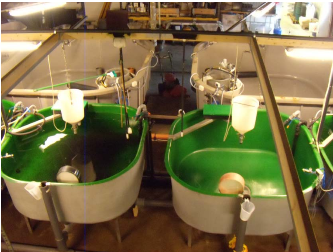
Figur 4-4. Udsnit af anlægget, der blev brugt til foder tæthedsforsøg.
