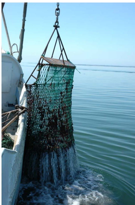
Figur 16. Den lette skraber. Den lette skraber er meget lig den lette østersskraber. Skraberammen er lettere og en dykkeplade sikrer et godt bundgreb.
