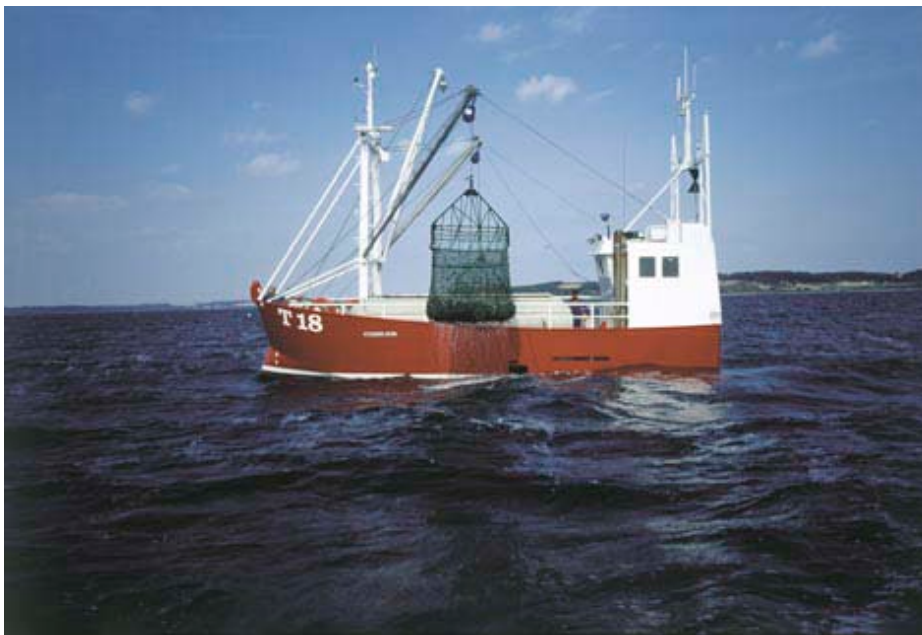
Figur 3. Et muslingefartøj fra Limfjorden med ophængt muslingeskraber af den hollandske type. (Kilde: www.limfjorden.dk )
