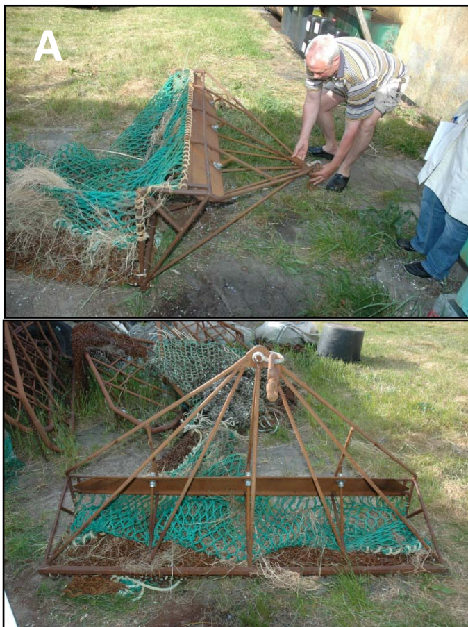
Figur 15. Fur-skraberen. Fur-skraberen er meget lig den lette østersskraber. Skraberammen er lettere og en dykkeplade sikrer et godt bundgreb. A) Fur-skraberen fra siden og B) Fur-skraberen set forfra. Fotos: Per Dolmer.
