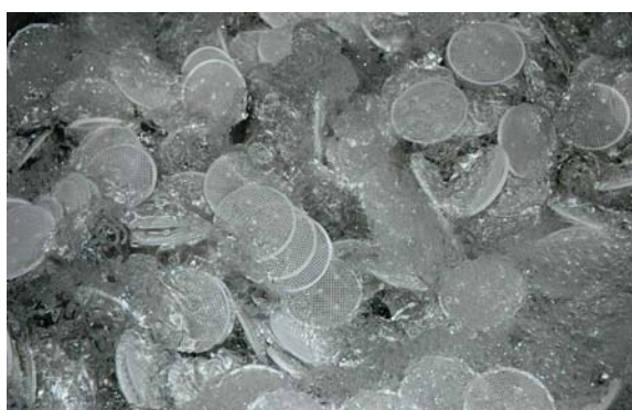
Figur 2.1. AnoxKaldnes BiofilmChip™ M; ca. 160.000 styk/ \text{m}^3 med en beskyttet specifik overflade på 1200 \text{ m}^2/\text{m}^3 .
