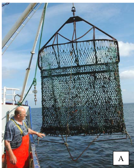
Figur 4. Den korte muslingeskraber – tippemekanismen ses nederst (A). Tegning og mål af tippemekanisme (B).
