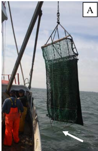
Figur 5. Den lette skraber med plastnetbund, rør og gummibund. A) Jernramme til tipning (pil). B) Plastnetbund med rør påmonteret og gummibund. C) Plastnetbunden kunne ikke holde til vægten af muslingerne og skraberen gik helt fra hinanden ved 2. skrab.
