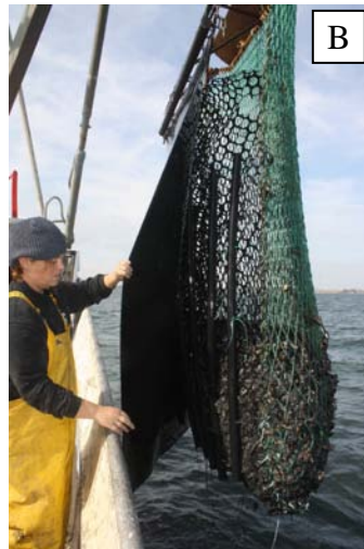
Figur 5. Den lette skraber med plastnetbund, rør og gummibund. A) Jernramme til tipning (pil). B) Plastnetbund med rør påmonteret og gummibund. C) Plastnetbunden kunne ikke holde til vægten af muslingerne og skraberen gik helt fra hinanden ved 2. skrab.
