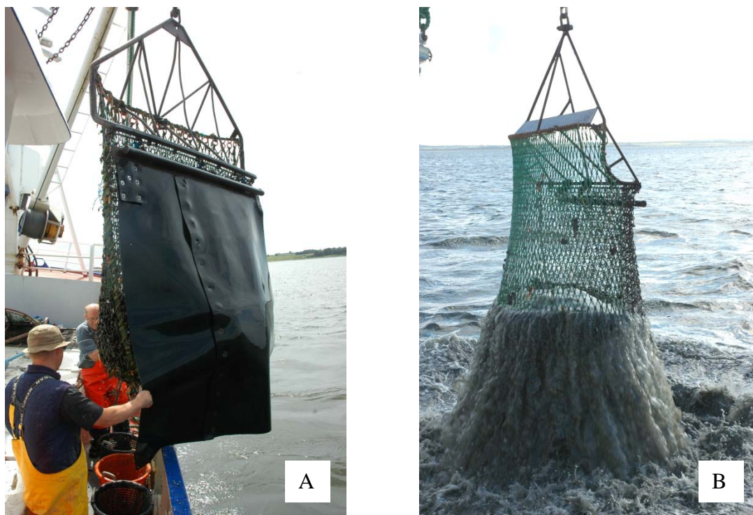
Figur 5. Den almindelige muslingskraber med gummimåtte (A) og den lette muslingskraber (B).
