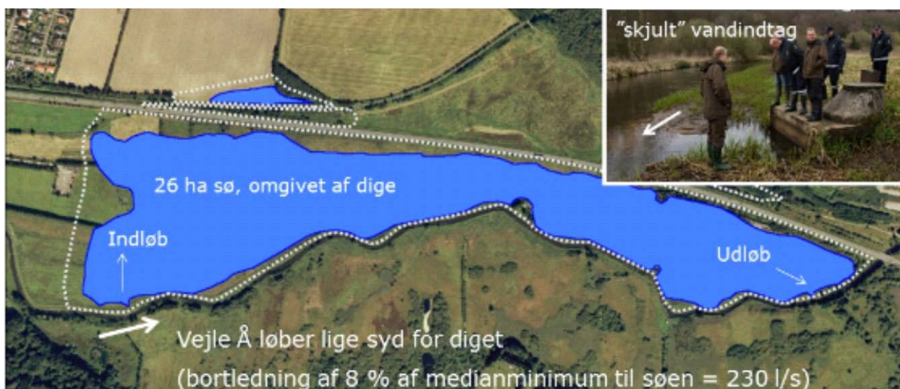
Figur 25. Ved Skibet i Vejle har man ført åen udenom søen, og lavet et "skjult" vandindtag, som kun ganske få fisk (19 eller estimeret 0,1 % af smoltene) trækker ind gennem. En lignende løsning ved Egå Engsø kunne være godt for ørredbestanden.
