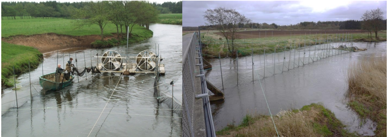
Smoltfælden i Skjern Å ved Borriskrog Bro er ved at blive renset. Fælden bestod i en såkaldt Rotary Screw Trap samt to lede-rader.
