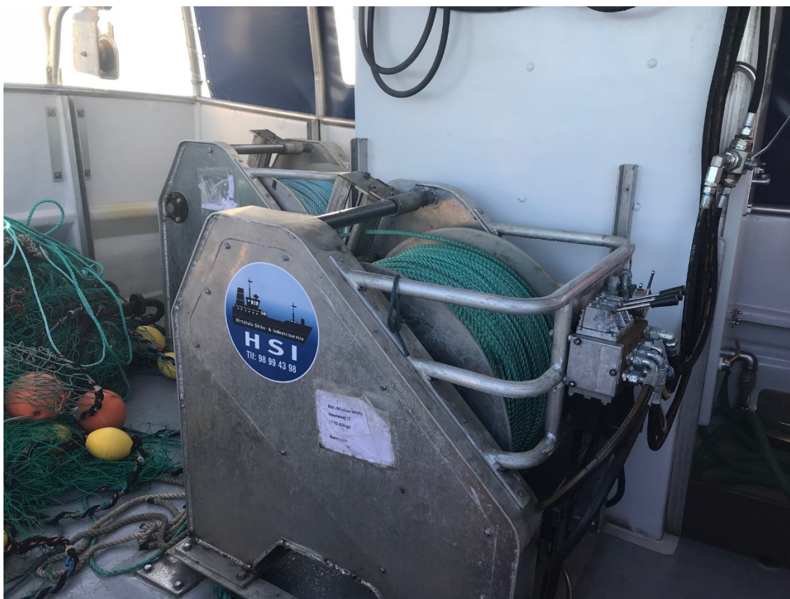
Figur 4.2. Snurrevoddspillene installeret ombord på R252 Ramona.
