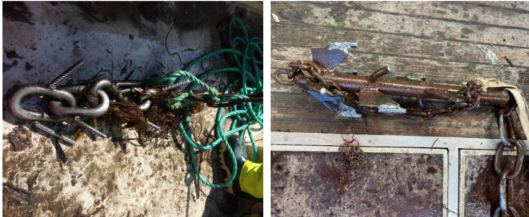
Figur 5. Eksempler på to forskellige typer dræg anvendt af erhvervsfiskerne til lokalisering af spøgelsesnet.
