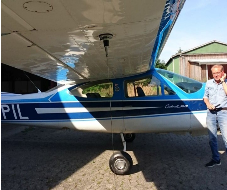
Billede 14. Privatfly med monteret antenne til pejling af radiomærkede ørreder.
