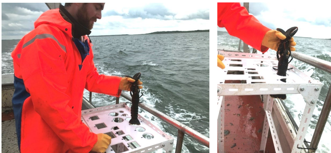
Figur 8.8. Forsøgsopstilling med plade med "udslipshuller" og en hummer, der holdes i klørne. Halefligene samles så det ikke er dem, der forhindrer gennemfald.
