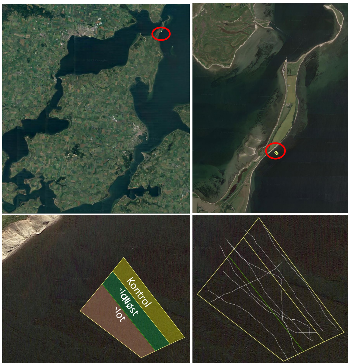
Figur 3.8. Kort over Mors samt tegning for placering for aktiviteten omkring brugen af en flydende grødehøster til fjernelse af butblæret sargassotang. Ud for kysten ved Fegge Klit markeres et reelt stort felt som opdeles i et kontrolområde uden høstaktivitet (gult felt) og en høstfelt (grønt felt). De lilla streger er GPS-sporet for en mindre båd som trak et videokamera igennem felterne før og efter høsteaktiviteten.
