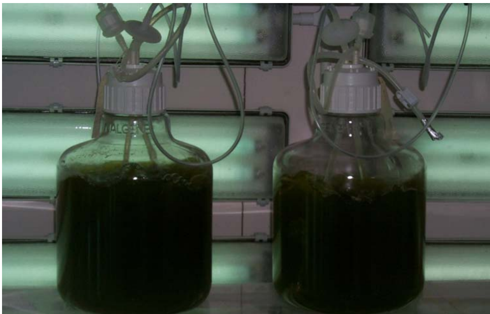
Fig. 2.12. Algekultur i Nalgene® flasker som kan steriliseres. Igennem låget er der kobling til luft, CO 2 (bemærk sterilt luftfilter), næringssalte og saltvand samt mulighed for manuel aftapning. Lys fra lysstofrør i baggrunden. Foto: Josianne G. Støttrup
