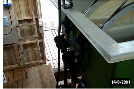
Fig. 2.8. Vandet tilføres UNIK filter fra den ene side og føres igennem 2 filtre af forskellig størrelse monteret på 2 roterende hjul. Til venstre ses vanddyser, der spuler vand tilbage gennem filteret og dermed presser de fangede zooplankton væk fra filteret til et opsamlingsrør, der føres ud ved siden af UNIK filteret (ses i billedet til højre). Fotos. Josianne G. Støttrup.
