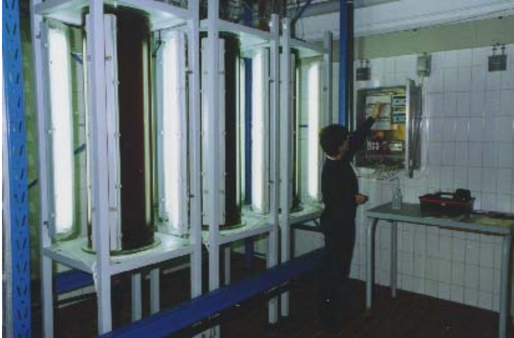
Fig. 2.14. Kontinuerligt algedyrkningssystem på Nordsøcentret, producerende dagligt 60 liter af hhv. Isochrysis galbana , Rhodomonas baltica og Tetraselmis suecica . Den daglig pasning bestod af en pH måling. Rengøring af den indre del af beholderen var overladt til en population af Tisbe holothuriae . Kulturen fungerede uafbrudt i 7 måneder før den blev taget ned og flyttet. Foto: Josianne G. Støttrup.
