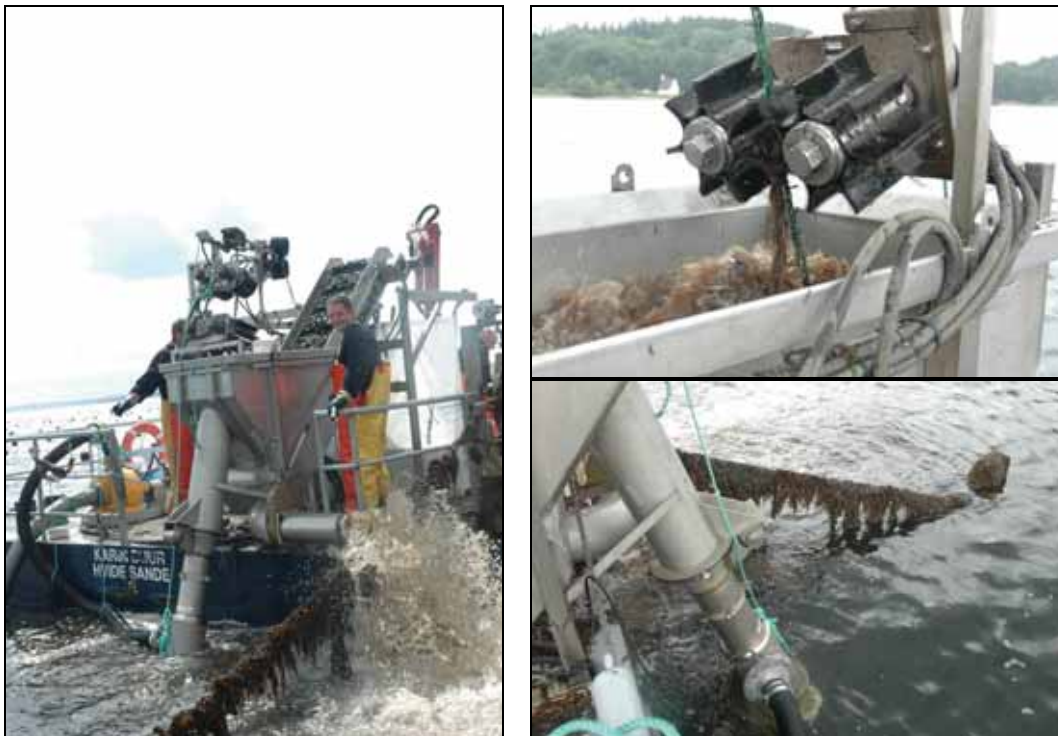
Figur 22. Høstmaskineri med venturipumpe, afstripper og transportbånd (til venstre). Øverst til højre afstripper i forbindelse med venturipumpe. Nederst til højre venturipumpe.
