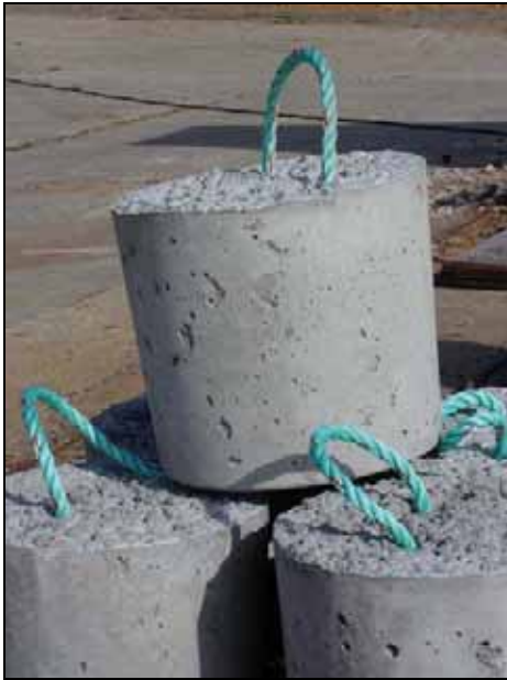
Figur 10. Blokanker støbt i murespand.
