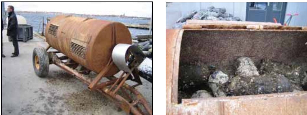
Figur 16. Maskine udviklet til bøjerensning (til venstre). Bøjer klar til at blive rensede i bøjerensningsmaskinen (til højre).
