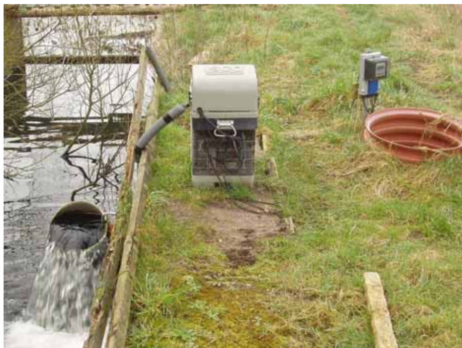
Figur 4.1 Installation med flowmåler og ISCO Glacier prøvetager. Udløb Rens Dambrug
