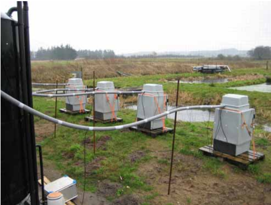
Figur 3-3a. Isco-prøvetagere tilkoblet pilotfilterne.
