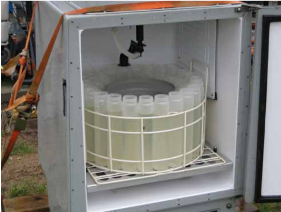
Figur 3-3b. Isco-prøvetager som udtager prøver i den 24-flasker-store prøvekarusel.
