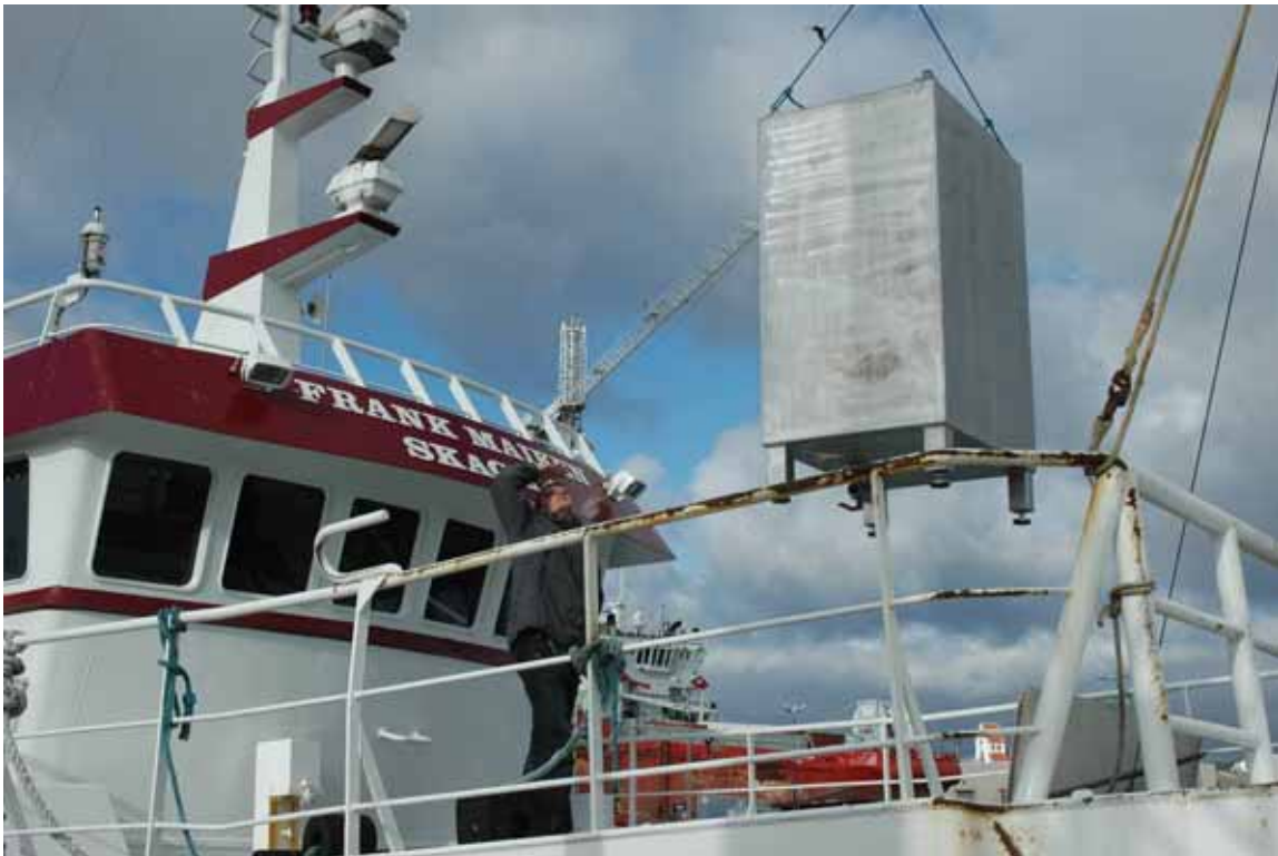
Fig. 5. A (øverst) Køletanken til båden under opbygning (set ind i tanken). Langs siderne ses kølerørene, i bunden luftslangen. B (nederst) En af køletankene hejses ombord på båden.
