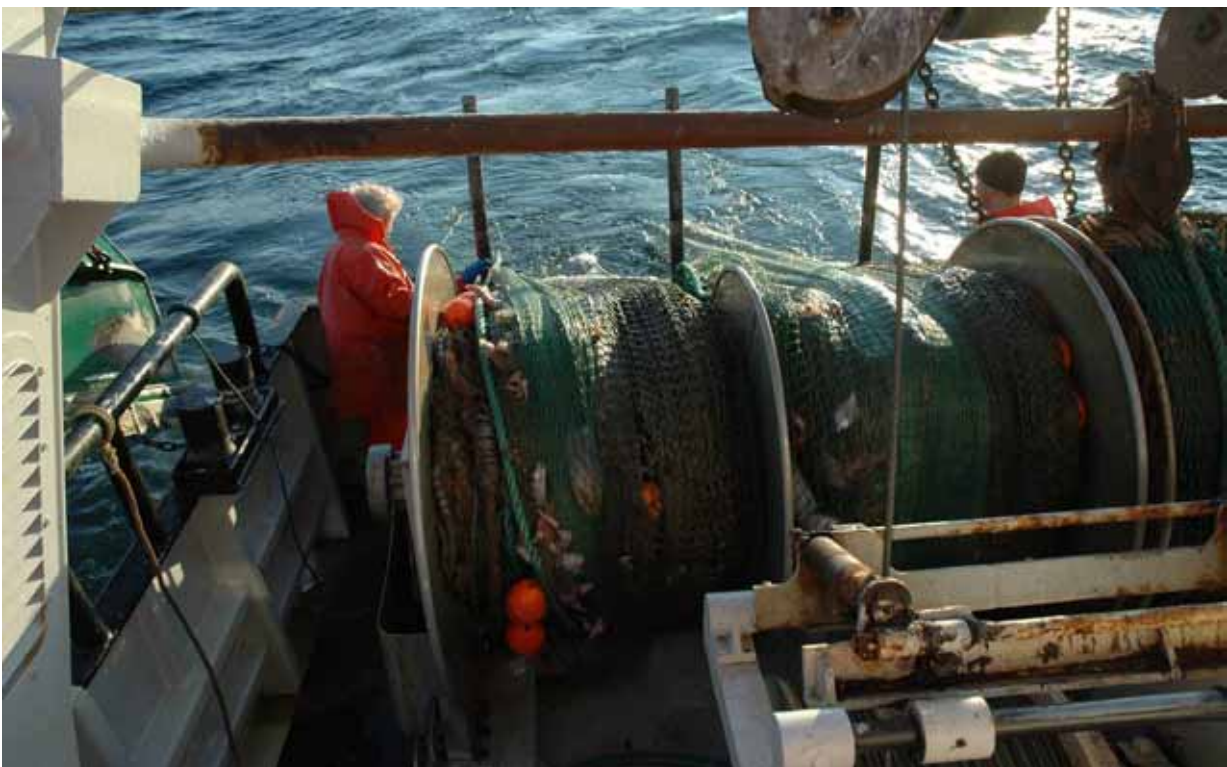
Fig. 7 A (øverst) Sorteringsbordet foran paunen hvor fangsten tømmes i. Bagest ses en kassette anbragt i et stativ på sorteringsbordet. B (nederst) Trawlet er ved at blive bjerget og køres op på tromlerne på hækken.
