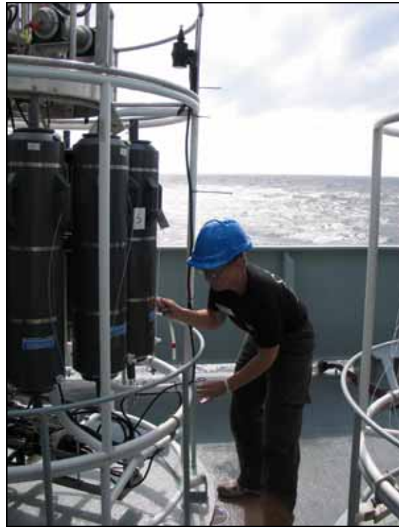
Fig. 35 CTD'en (Conductivity-Temperature-Depth) er ved at blive klargjort inden den bliver sænket ned gennem vandsøjlen
