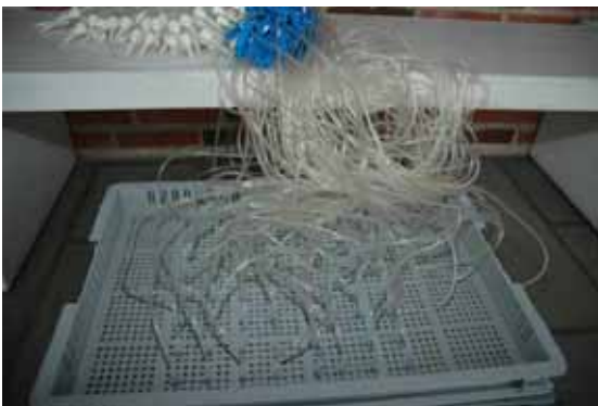
Fig. 24. Til befugtning ved dryp blev anvendt infusionsæt, ét til hvert rum i kassetten. Tv. ses låget til kassetten, med infusionslangerne monterede. Th. ses slangernes udmunding på undersiden af låget, der er tilpasset så de passer præcist ned midt i hvert af rummene i kassetten .
