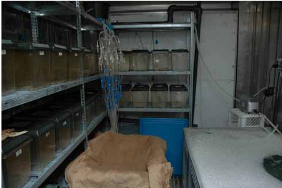
Fig. 25. Indretning af Container 2. Tv. på reolerne ses 15 l akvarierne, der blev benyttet til ammonium excretions forsøgene. Bagest drypsystemet, kassetten i det isolerede kar var dækket med fugtet jutestof. Til højre ses et af de 3 kar til opbevaring af hummere.
