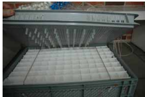
Fig. 24. Til befugtning ved dryp blev anvendt infusionsæt, ét til hvert rum i kassetten. Tv. ses låget til kassetten, med infusionslangerne monterede. Th. ses slangernes udmunding på undersiden af låget, der er tilpasset så de passer præcist ned midt i hvert af rummene i kassetten .
