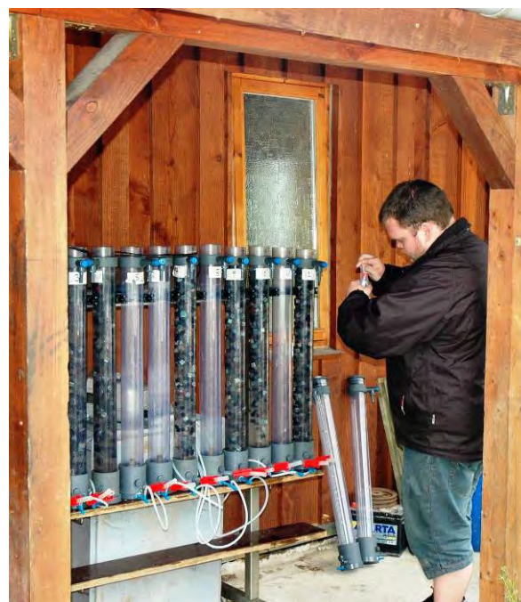
Figur 4.8. Biofiltersektioner fra model 3-dambrug, og nedenfor forsøgsopstilling med biofilterelementer udsat for forskellig behandling. I hvert delforsøg med samme mængde biofilter-elementer tilsættes en kendt mængde \text{NH}_4\text{Cl} eller \text{NaNO}_2 og der udtages vandprøver over tid til senere analyser. [Foto: LFP]
