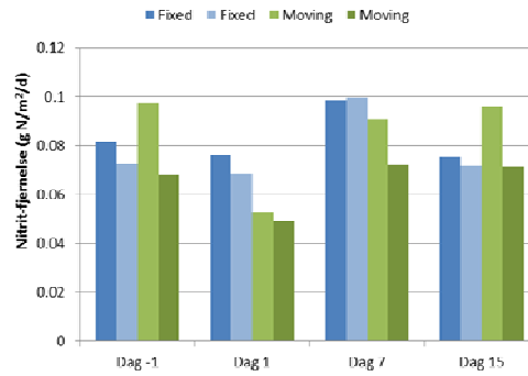
Figur 1.6.2. T.v. Ammoniumfjernelses rater (0. orden) dagen før retur skylning (dag -1) og hhv. 1, 8 og 15 dage efter. T.h. ses tilsvarende 0. ordens rater for nitrit oxidationen.
