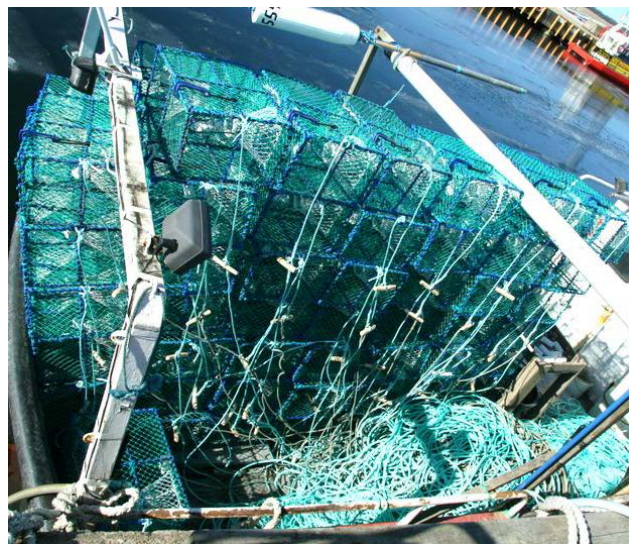
Fig. 4. Eidern Valborg klar til afgang med 5 lænker (125 tejner) rigget og klar til sætning. Færdsel på dækket undgås, så linerne ikke bliver viklet sammen. Af billedet ses vigtigheden af, at tjavsernes længder er afstemt efter bådens størrelse.
