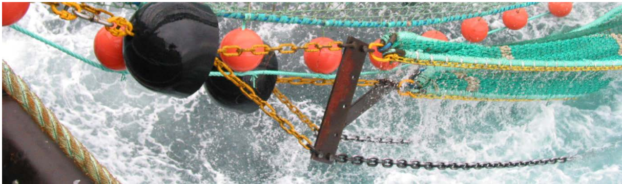
Figur. 4.6.1.1. Billeder viser hvordan fiskelinen løftes ca. 80 over bunden ved hjælp af en hanefod og en metalstav helt fremme i redskabets vinge.
