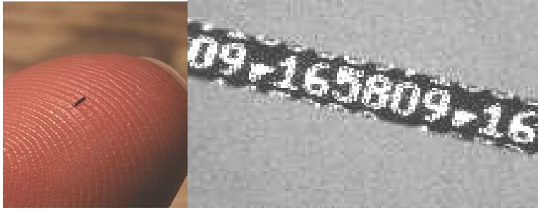
Figur 4: Til venstre et Coded Wire (CW) mærke. Det er ca. 1 mm langt og 0,25 mm i diameter. Til højre et eksempel på et serie nr. der kan aflæses på selve mærket ved hjælp af et stereolup.
