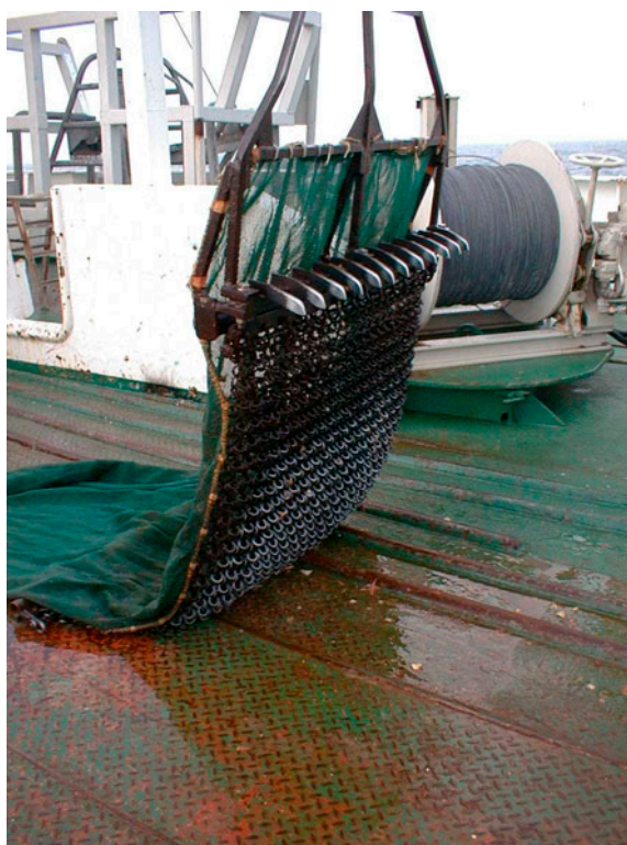
Figur 4. Modificeret muslingskraber, anvendt på videnskabelige togter til kortlægning af udbredelse og måling af relativ tæthed af tobis i havbunden.
