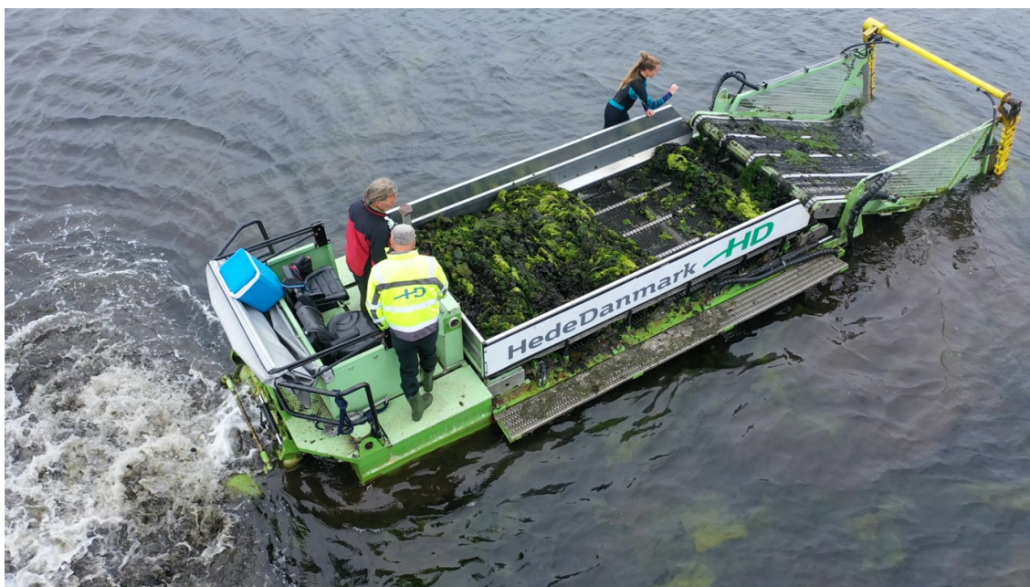
Figur 3.2.3. Høst af eutrofieringsbetingede masseforekomster af søsalat i næringsrige fjordområder kan gøres skånsomt med høstmaskiner udviklet til grødeskæring i søer. Her høst i Skive Fjord 2019 (Foto: Michael Bo Rasmussen).
