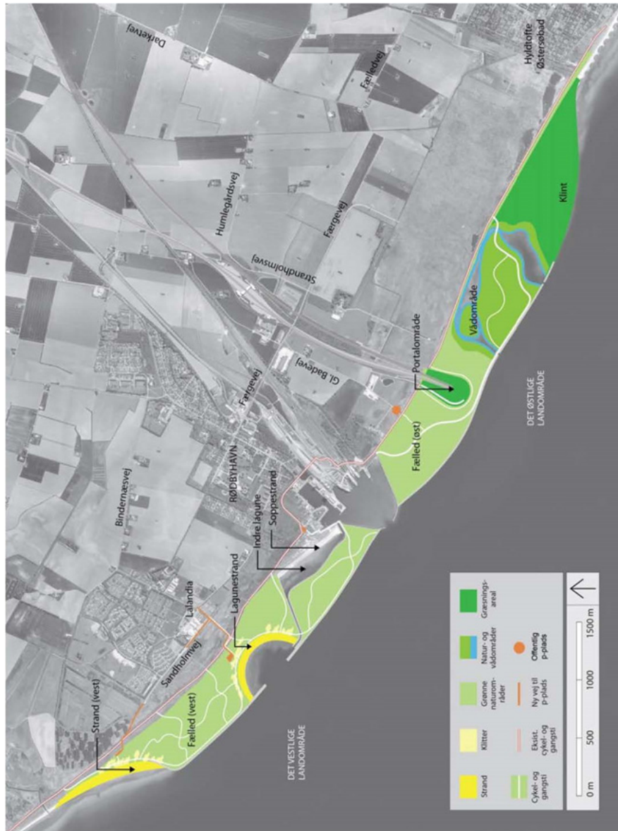
Figur 5. Vision for genanvendelse af opgravet marint materiale omkring Rødby Havn i forbindelse med etableringen af Femern forbindelse – se Lov om anlæg og drift af en fast forbindelse over Femern Bælt med tilhørende landanlæg i Danmark (retsinformation.dk).
